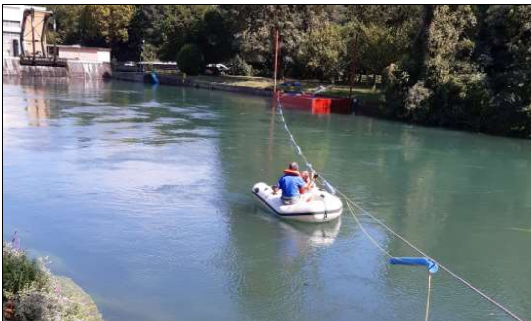
Fase di preparazione dello stendimento geoelettrica nel fiume Piave
