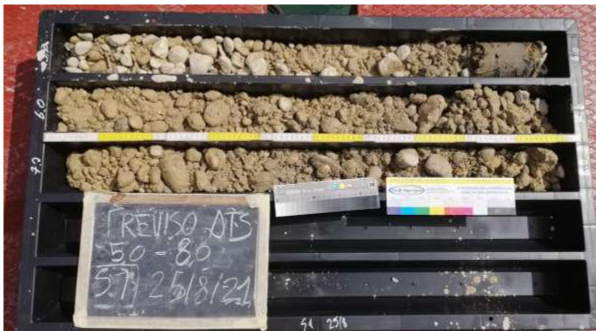
Fotografia sondaggio S1 con litologie dai 0.0 ai 5.0 m dal fondo
