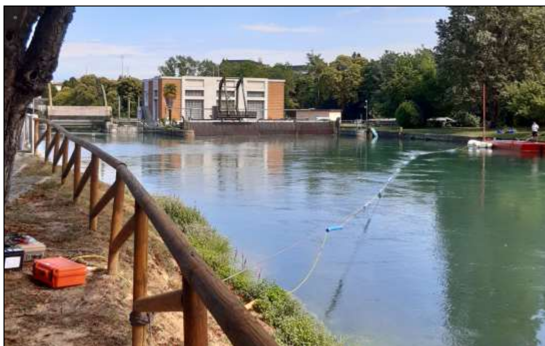
Foto esecuzione della prova di geoelettrica in sito
