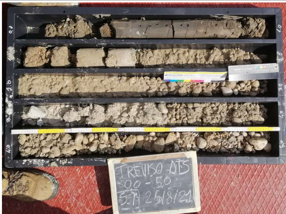
Fotografia sondaggio S1 con litologie dai 0.0 ai 5.0 m dal fondo
